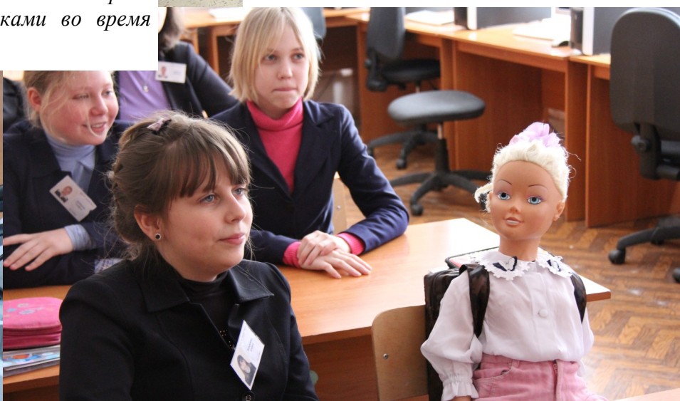
Проект «А.Л.Л.А» Калягиной О.Ю., Слезина К.А. и выпускницы 11К класса Александровой Натальи. «АЛЛА» - роботизированная кукла, способная заменять ученика на уроке во время длительной болезни. Она может транслировать ход урока по сети Интернет ученику на дом и его ответы учителю в режиме on-line.
