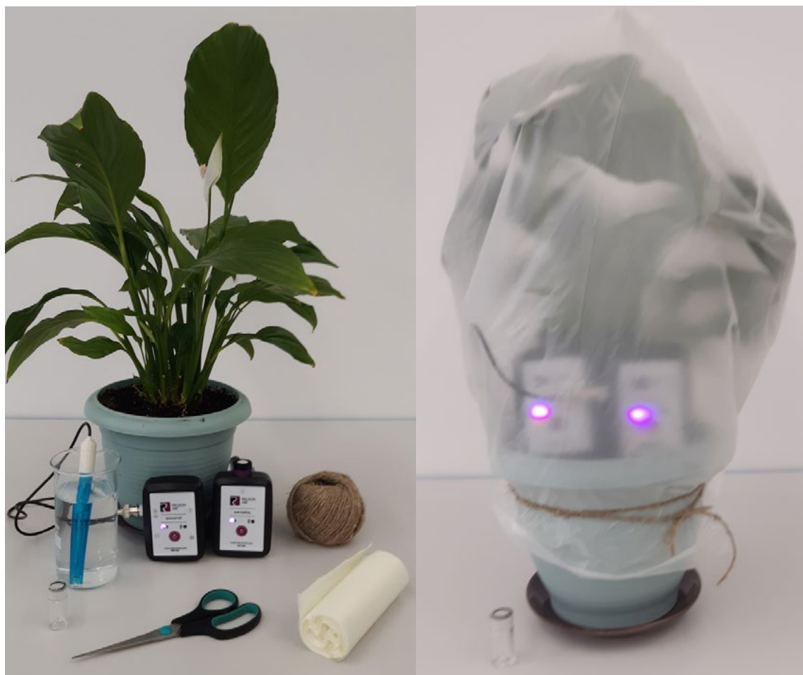
Рис. 25. Общий вид растения и необходимых материалов перед началом опыта (слева) и после сбора экспериментальной установки (справа)
